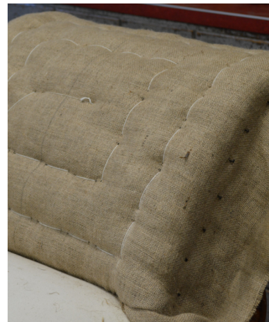
2 Nachdem ein Graben mit Werg gefüllt wurde, ist wieder geborgenes Afrik für die Fassung aufgelegt worden.
